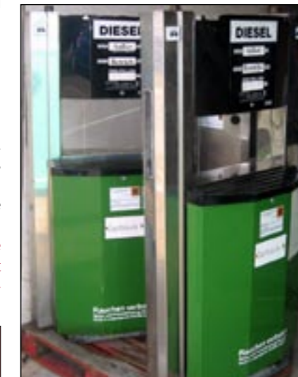
2 Zapfsäulen Typ Hünert Comet (oben links) je 1 Abgabepunkt 150 und 50 Liter/Min.
